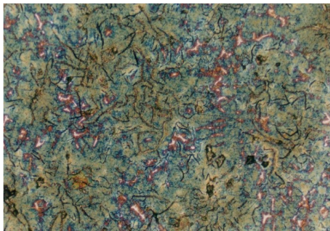
Gambar 26. Foto Struktur Mikro Temper 200° C Perbesaran 100 X
