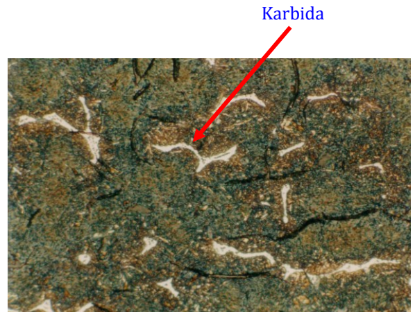
Gambar 30. Foto Struktur Mikro Temper 400° C Perbesaran 100 X
