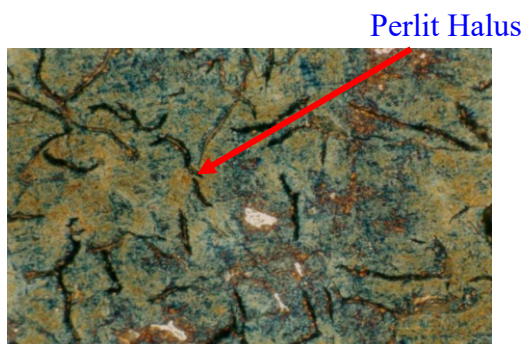
Gambar 29. Foto Struktur Mikro Temper 300° C Perbesaran 500 X
