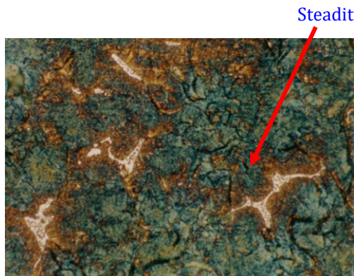
Gambar 26. Foto Struktur Mikro Temper 200° C Perbesaran 100 X
