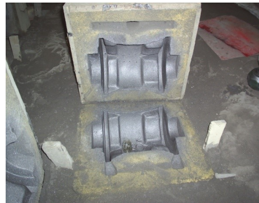
Gambar 8. Foto Hasil Cetakan Pasir Basah Setelah diberi bubuk grafit
