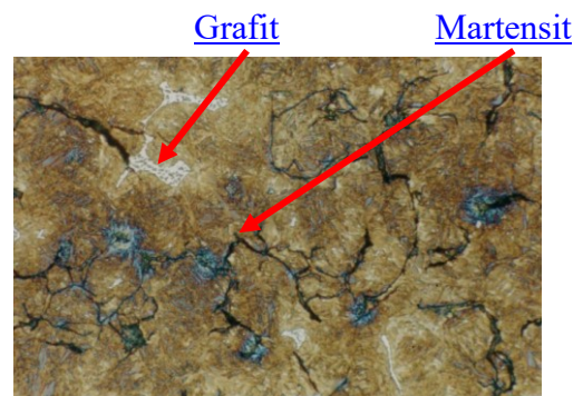
Gambar 25. Foto Struktur Mikro Temper 100° C Perbesaran 500 X
