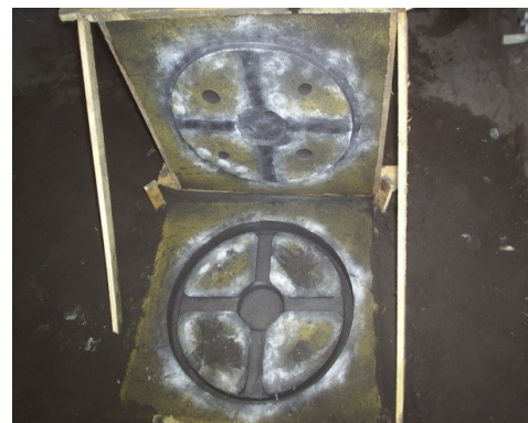
Gambar 9. Foto Hasil Cetakan Pasir Kering Setelah disemprotkan bubuk grafit
